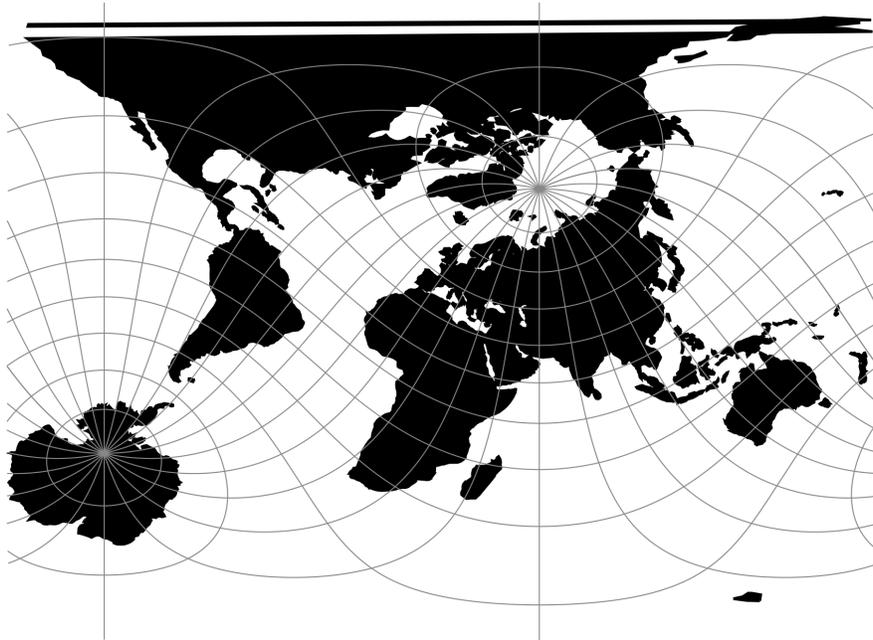
Fig. 82: proj-string: `+proj=ob_tran +o_proj=mill +o_lon_p=40 +o_lat_p=50 +lon_0=60`
